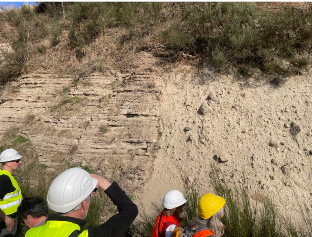
Abb. 10: Blockführender Lapillituff (Diatremfüllung) schneidet die Tuff- und Lapillilagen der Gleys- Bims-Eruption diskordant (Steinbruch Fa. Rick, Gleys)
